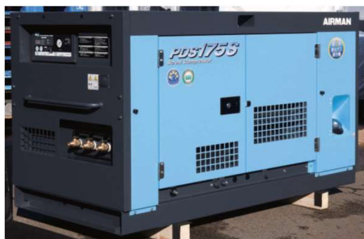
50HPコンプレッサー
